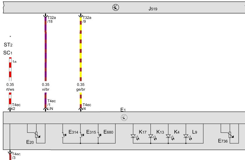
车灯开关, 挡风玻璃投影 (平视显示) 按钮, 车载电网控制单元
